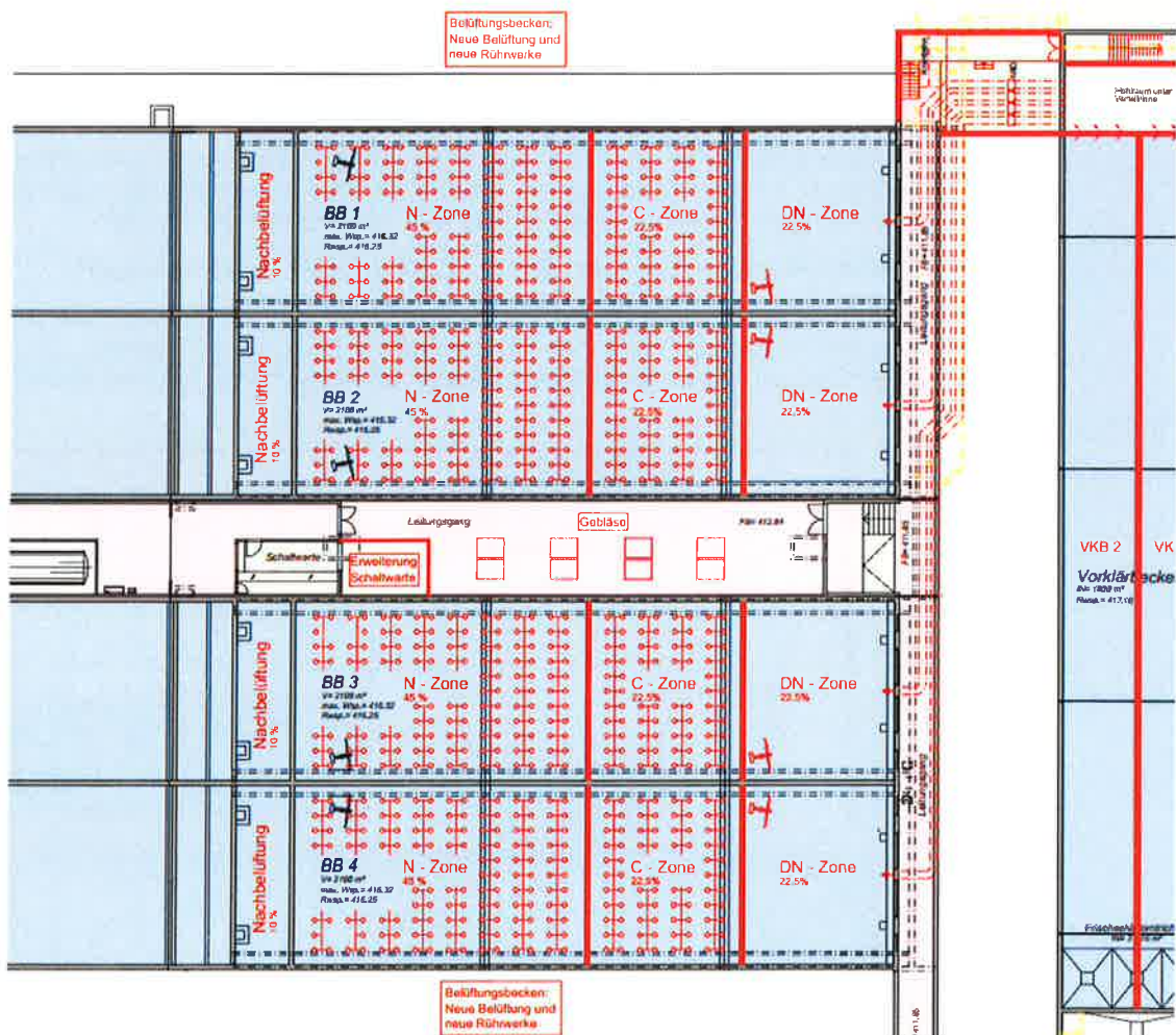
Abbildung 5.5: Situation einer möglichen Anordnung des Wirbelbett-Hybrid / S-Select® – Verfahren, inkl. Gebläsestation.
