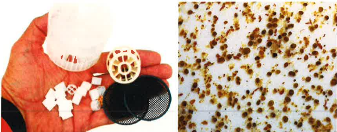
Abbildung 5.4: Trägermaterial von verschiedenen Systemanbietern (von möglichen Wirbelbett-Hybrid – Verfahren (links), vom S-Select®-Verfahren (rechts)).
