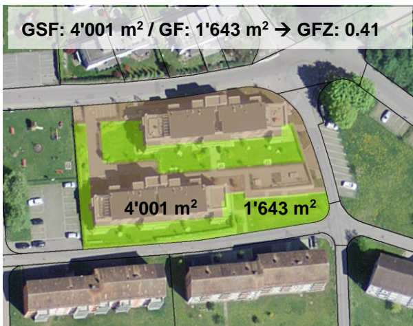
Die Abbildung zeigt ein Beispiel, bei welcher die Grünflächenziffer von 0.35 mit 0.41 eingehalten wurde (GSF: Grundstücksfläche / GF: Grünfläche / GFZ: Grünflächenziffer).
